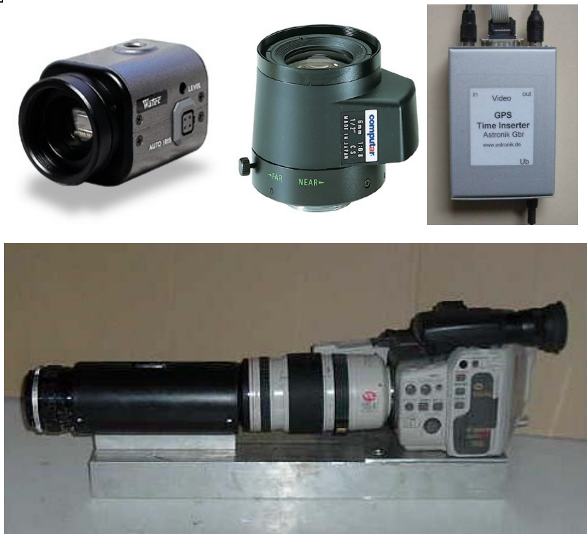
Εικόνα 4.2.1. Αισθητήρες και οπτικά συστήματα που χρησιμοποιούνται στην καταγραφή μετεώρων. Πάνω Αριστερά: Μια videocάμερα χαμηλού φωτισμού (Low Light Level) τύπου Watec 902 DM2S. Πάνω Κέντρο: Ασφαιρικός φακός εστιακής απόστασης 6 χιλιοστών της Computar. Πάνω Δεξιά: Συσκευή εισαγωγής χρόνου GPS, TIM-10. Κάτω: Camcorder Canon L2 Super-8 εφοδιασμένο με έναν ενισχυτή εικόνας (Image Intensifier) τύπου Micro Channel Plate (MCP) 25 χιλιοστών δεύτερης γενιάς (Gen II).
