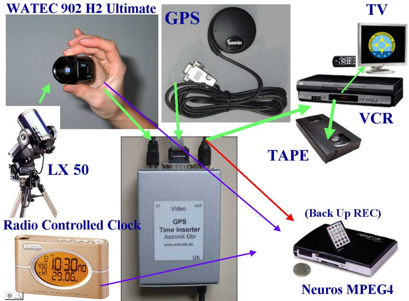
Σχ 2: Διάγραμμα του εξοπλισμού μας και της διασύνδεσης των διαφόρων συσκευών. Με πράσινα βέλη είναι η συνήθης διάταξη, ενώ με κόκκινο και μοβ βέλη σημειώνεται η εναλλακτική (back up) διάταξη.
